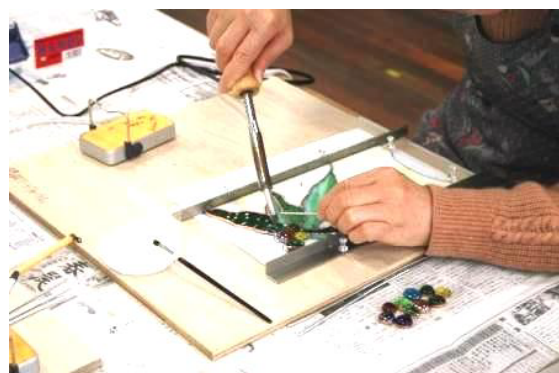
②カットしたピースを組み込み、はんだ付け
